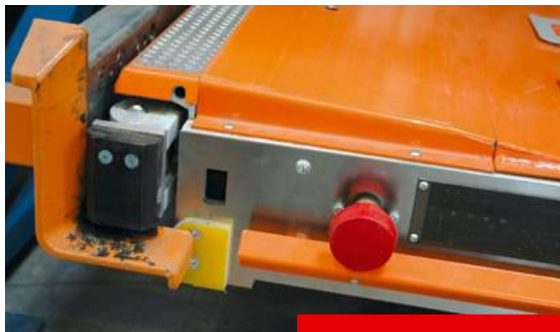
Z przodu platform umieszczone są szczotki oczyszczające szynę z miękkich i twardych przeszkód.
